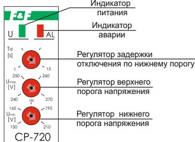
Реле контроля напряжения CP-720 выполнено в одномодульном корпусе для крепления на DIN-рейку 35мм. На передней панели находятся индикатор питания, индикатор аварии, регуляторы нижнего и верхнего порога отключения и регулятор задержки отключения по нижнему порогу напряжения.
